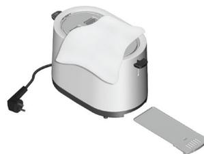
**3. Nettoyage et entretien :** débranchez le grille-pain et laissez-le refroidir. Videz le tiroir ramasse-miettes. Essayez les surfaces extérieures à l'aide d'un chiffon légèrement humide. **Ne jamais utiliser de produits nettoyants caustiques ou abrasifs et ne jamais placer le grille-pain sous l'eau !**
