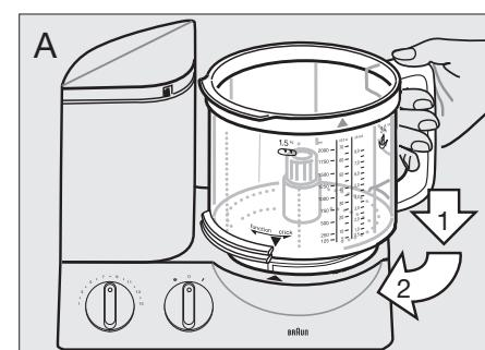
recipiente con la flecha de la base del motor (A). Luego gire el recipiente hacia la dirección de «function» hasta que llegue a su tope.
