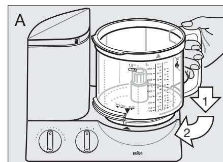
2. Namestite želeni nastavek (glejte navodila za posamezne nastavke) na pogonsko gred posode in ga potisnite, da se zaskoči.
