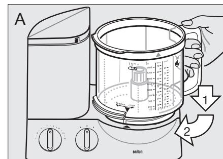
2. Встановіть необхідне пристосування (див. інструкцію для кожного пристосування) на приводний вал ємності та натисніть на нього вниз до тих пір, поки він не досягне крайнього нижнього положення.
