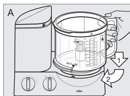
Drehen Sie dann die Universalschüssel in Pfeilrichtung «function» bis zum Anschlag.
