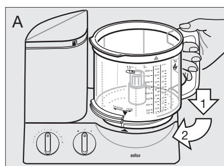
2. Τοποθετήστε το εξάρτημα που χρειάζεσθε (δείτε τις οδηγίες για κάθε εξάρτημα ξεχωριστά) στον οδηγό του μπολ, αυτή τη φορά και πιέστε το προς τα κάτω να σταθεροποιηθεί.
