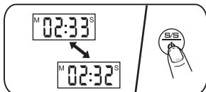
3. Для остановки таймера нажмите на любую кнопку на весах. Для возобновления работы таймера - нажмите на кнопку «**S/S/[Ø]**». Для обнуления таймера нажмите одновременно кнопки «**MIN/G/LB**» и «**SEC/TARE**».
