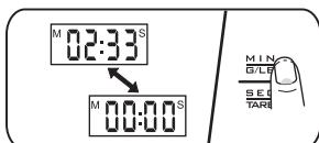
4. Для того, чтобы включить таймер с отсчетом времени в прямом направлении - обнулите показания таймера (одновременно нажмите кнопки «**MIN/G/LB**» и «**SEC/TARE**») и после этого нажмите на кнопку «**S/S/[Ø]**» - начнется отсчет времени в прямом направлении. Максимальное время таймера составляет 99 минут 59 секунд.
