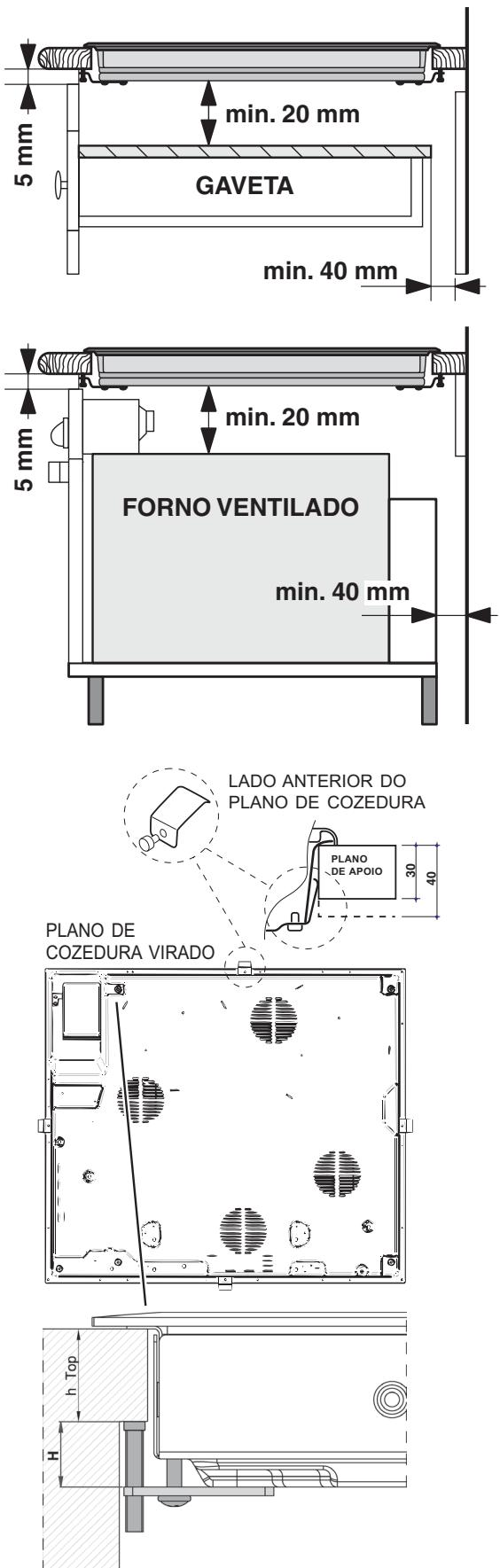
A instalação do aparelho deve ser realizada sobre uma superfície de apoio perfeitamente plana. As deformações eventualmente provocadas por uma fixação errada poderão alterar as características e as performances do plano de cozedura.
