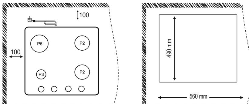
Внешние размеры, указанные цифрами, определяют стандартные размеры плиты на столешнице. После того, как столешница подготовлена, обратитесь в обслуживающий центр для установки плиты. Позвоните в уполномоченный сервисный центр.
