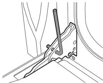
2. Взять дверцу за обе стороны двумя руками рядом с петлями, приподнять ее под углом приблизительно 30° и вынуть.
