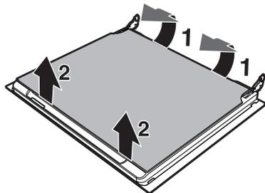
3. На многофункциональных моделях имеется промежуточное стекло. Снять промежуточные стекла, приподнимая их кверху.
