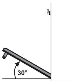
3. Чтобы снова установить дверь, вставить шарниры в подходящие щели, расположенные на духовке, так, чтобы шлицы **A** полностью прислонялись на щели. Опустить дверцу вниз и после ее установки вынуть стержни из отверстий петель.
