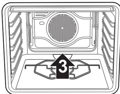
Поставить на место основание плитки пиццы, подталкивая ее до упора с задней частью плиты и давая вклиниться в пластинку сопротивления на основании самой плиты.
