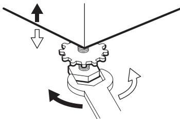
Тщательное выравнивание предотвращает вибрацию, шум и перемещение машины во время работы.
