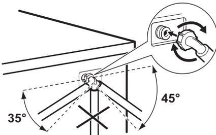
3. Отрегулируйте положение шланга, ослабив зажимную гайку. Отрегулировав положение шланга, не забудьте плотно затянуть зажимную гайку во избежание утечек.
