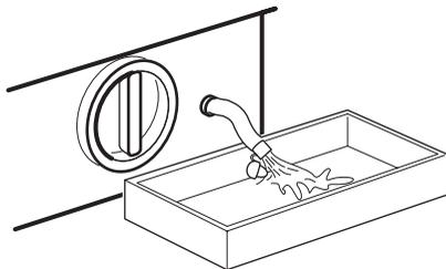
5. Когда вода перестанет литься, отвинтите против часовой стрелки крышку насоса (А) и извлеките фильтр. При необходимости используйте плоскогубцы. Всегда держите под рукой тряпку, чтобы вытереть воду, которая может пролиться при снятии фильтра. Очистите фильтр сливной трубки от следов ворса.
