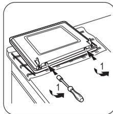
**4** Положите дверцу на устойчивую поверхность, покрытую мягкой тканью. Используйте отвертку, чтобы извлечь 2 винта с нижнего края дверцы.
