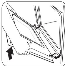
**3** Прикройте дверцу до первого фиксируемого положения (напольвину). Затем потяните дверцу на себя и извлеките петли из гнезд.
