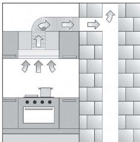
**Рекомендуем использовать вытяжку в режиме отвода воздуха в вентиляционную шахту.**
