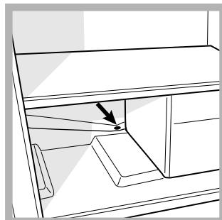
Холодильная камера оснащена системой автоматической разморозки: вода сливается в заднюю часть изделия через специальное сливное отверстие (см. рисунок), после чего она испаряется под
