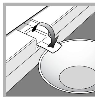
5. Некоторые изделия оснащены системой слива, сливающей воду наружу: вставьте прилагающийся скребок в специальное отверстие в основании изделия, по которому вода будет стекать в любую подходящую емкость (см. рисунок).
