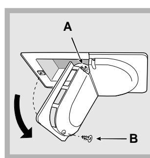
Отвинтите крепежный винт (B), расположенный в задней части плафона, откройте плафон с лампочкой (A), как показано на рисунке (см. рисунок). Замените лампочку на новую такого же типа мощностью не более 15 Вт.
