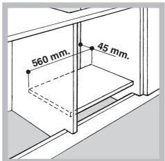
Если варочная панель устанавливается сверху встроенного духового шкафа, не оснащенного принудительной охладительной вентиляцией, для надлежащей вентиляции внутри кухонного элемента необходимо проделать вентиляционные отверстия для циркуляции воздуха (см. чертежи).
