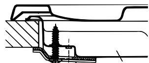
Монтаж крюка для опорных брусков **H=20 мм**
