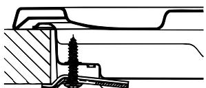
Монтаж крюка для опорных брусков **H=30 мм**
