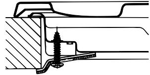
Монтаж крюка для опорных брусков **H= 40 мм Сзади**
