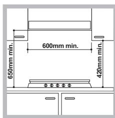
Если варочная панель устанавливается под навесным шкафом, последний должен располагаться на высоте не менее 700 мм от кухонного топа (см. рисунок).
