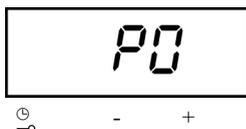
Если таймеру отключения задана программа и в это время прекращается подача электроэнергии, в качестве мер предосторожности будут выключены все запрограммированные конфорки. Как только возобновится подача электроэнергии, на дисплее появятся знаки **PO**. Чтобы снова задать программу таймеру, нажмите на любой символ, дисплей погаснет, и варочную панель можно будет снова запрограммировать.
