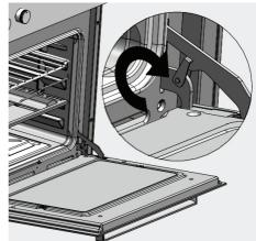
Для демонтажа и установки дверцы духовки следуйте нижеприведенным инструкциям.
