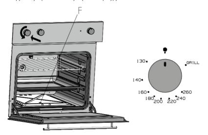
Для упрощения определения положения минимума термостат в этом положении имеет стопор. Для отключения горелки из положения минимума слегка нажмите на рукоятку и поверните ее в положение При использовании горелки духовки горелку гриля включить невозможно. Горелка оборудована предохранительным клапаном, блокирующим подачу газа, если пламя неожиданно погаснет. Запрещается использовать духовку для отопления домов или помещения, где она установлена.
