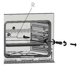
В данной модели, вертел расположен продольно посередине относительно задней части духовки. В этом случае блюдо устанавливается закрепленным вилочными держателями на раздвоенном вертеле. Закрепите на крюках раздвоенную стойку (R) на одной направляющей в соответствующих пазах (в зависимости от моделей). Во время приготовления не оставляйте рукоятку раздвоенного вертела в духовке.
