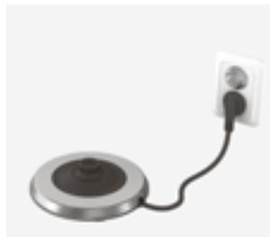
2. Posizionare la base su una superficie piana e stabile. Collegare il cavo di alimentazione ad una presa di rete. Il cavo in eccesso può essere avvolto sotto la base.
