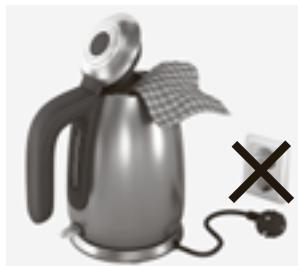
I 1. **Scollegare sempre l'apparecchio prima procedere alla pulizia.** Non sciacquare o immergere il bollitore o la base in acqua. Pulirli con un panno umido, senza usare detergente abrasivo. Ogni tanto sciacquare il bollitore sotto l'acqua.
