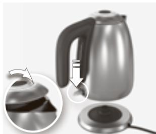
**4. Zavřete víko** a zkontrolujte, zda rádně zaklaplo. Pokud ne, funkce automatického vypnutí nebude fungovat správně. **Položte konvici na podstavec.** Stiskněte vypínač ZAPNUTO/VYPNUTO. Rozsvítí se kontrolka a konvice začne ohřívat.
