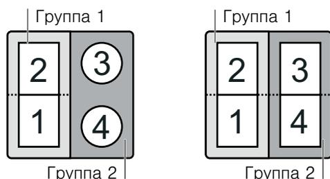
**Указание:** Включение функции Powerboost на конфорке с изменяемой площадью нагрева возможно при использовании этой конфорки в качестве одной единой конфорки. В этом случае поставьте посуду в центр конфорки с изменяемой площадью нагрева согласно указаниям раздела «Конфорка с изменяемой площадью нагрева».
