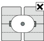
Если варочная панель имеет более одной конфорки с изменяемой площадью нагрева, не рекомендуется использовать для нагрева одной кастрюли или сковороды несколько таких конфорок одновременно.
