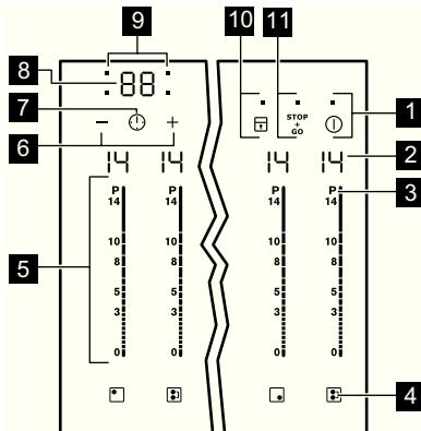
Құрылғыны іске қосу үшін сенсорлық өрістерді пайдаланыңыз. Бейнебеттер, индикаторлар мен дыбыстық сигналдар қай функциялардың жұмыс жасаітынын көрсетеді.
