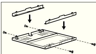
Якщо використовується захисний короб (додаткове приладдя<sup>1)</sup>), вентиляційний простір спереду (2 мм), а також захисне перекриття безпосередньо під приладом не потрібні. Не слід використовувати захисний короб при встановленні приладу над духовкою шафою.
