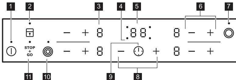
Керування роботою пристрію здійснюється за допомогою сенсорних кнопок. Символи на дисплеї, індикатори та звукові сигнали вказують, яка функція працює.
