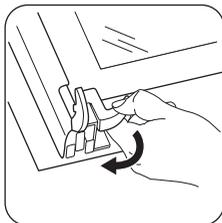
**5** Отожмите стопору, чтобы снять внутреннюю стеклянную панель.
