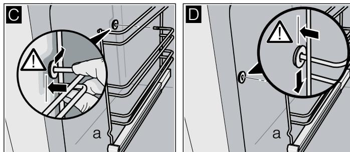
7. Задвиньте телескопические направляющие до упора и закройте дверцу прибора.
