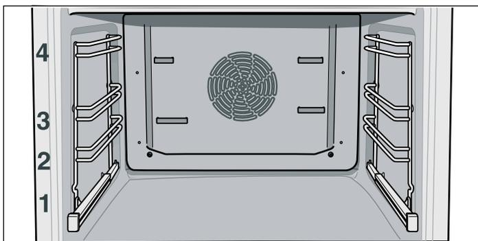
Рабочая камера имеет четыре уровня установки. Уровни установки считаются снизу вверх.
