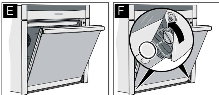
4. Прикройте дверцу, чтобы фиксаторы зафиксировались со слышимым щелчком.
