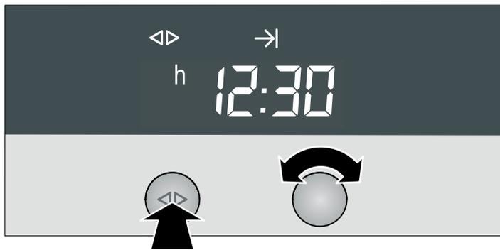
В установленное время окончания прибор автоматически выключается.
