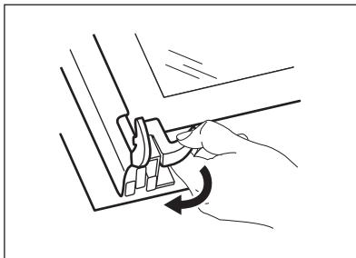
9. Поверніть два фіксатори на 90° і вийміть їх із гнізд.
