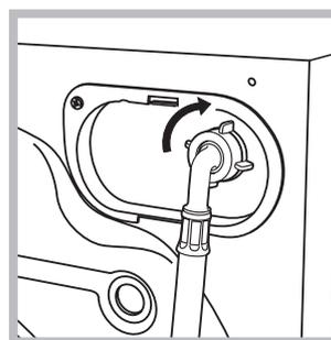
2. Подсоедините заливной шланг к стиральной машине, навинтив его на водоприемник, расположенный в задней верхней части справа (см. рис.).
