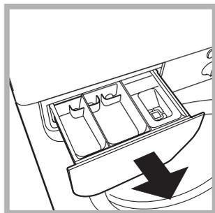
Вийміть касету, піднявши її та витягнувши назовні (див. малюнок). Промийте її під проточною водою; ця процедура має проводитися регулярно.
