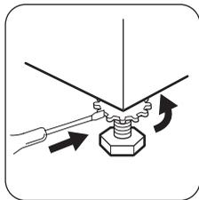
Необходимые регулировки следует выполнять с помощью гаечного ключа.
