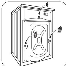
Вставьте в маленькое верхнее отверстие и в два больших отверстия соответствующие пластиковые заглушки, находящиеся в одном пакете с руководством по эксплуатации.
