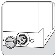
Вставьте заглушку обратно в шланг аварийного слива и установите его на место. Установите фильтр на место, аккуратно вставив его по направлению стрелки. Плотно закрутите крышку насоса, вращая ее по часовой стрелке.
