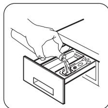
Вытяните до упора дозатор моющих средств. Отмерьте необходимое количество моющего средства, поместите его в отделение дозатора, предназначенное
