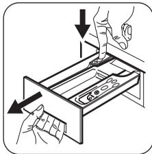
Извлеките дозатор, отжав вниз защелку и потянув его на себя. Чтобы удалить все остатки скопившегося порошка, промойте его проточной водой.
