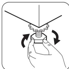
Выровняйте машину, поднимая или опуская ножки. Ножки могут регулироваться с трудом, т.к. на них установлены самозатягивающиеся гайки, однако **НЕОБХОДИМО** отрегулировать их высоту так, чтобы машина стояла ровно и устойчиво. При необходимости проверьте точность выравнивания с помощью уровня.
