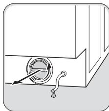
Когда вода перестанет течь, отвинтите крышку насоса, повернув ее против часовой стрелки, и извлеките фильтр. При необходимости используйте плоскогубцы. Всегда держите под рукой тряпку, чтобы вытереть воду, которая может пролиться при снятии фильтра. Очистите фильтр сливной трубки от следов ворса.
