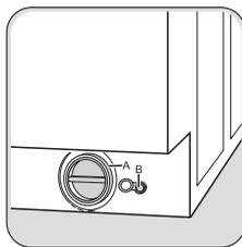
Поставьте рядом с насосом (A) емкость для сбора воды, которая может вытечь. Выньте шланг аварийного слива (B), поместите его конец в поставленный тазик и снимите с него заглушку.
