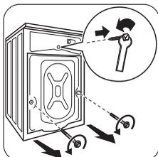
Вывинтите три болта входящим в комплект гаечным ключом.
