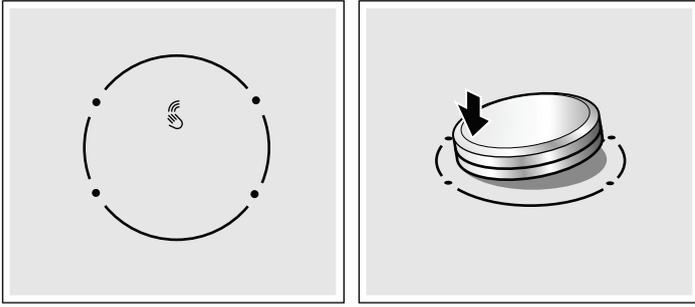
Контактная панель Turr-Pad является панелью управления, на которой с помощью переключателя Turr можно выбрать конфорку и уровень мощности. Переключатель Turr устанавливается по центру панели Turr-Pad автоматически.
