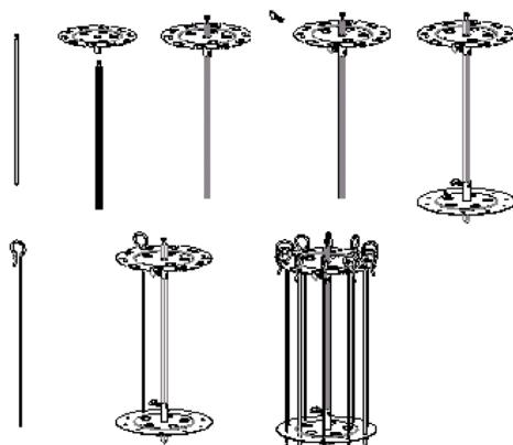
3. Сначала установите заостренный конец вертела в разъем в верхней части печи, а затем установите другой конец вертела в нижней части.
