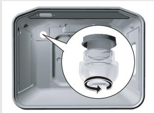
**Патрон лампочки духовки находится под напряжением. Опасность удара электрическим током!**
