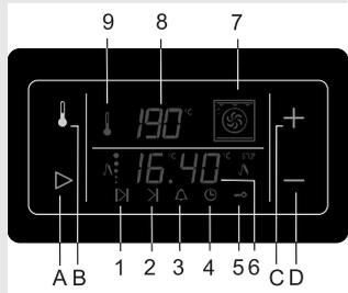
С помощью электронного программатора можно установить температуру духовки и функции, программирующие время работы духовки.
