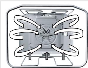
Для консервирования используйте режим
