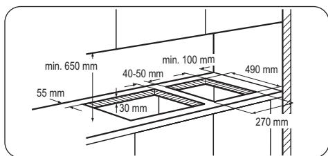
В случае, если несколько 30 см варочных панелей необходимо установить одну рядом с другой в одном вырезе столешницы, можно обратиться в сервисный центр за набором для монтажа, который включает в себя боковую опорную скобу и дополнительные уплотнители. Необходимые инструкции находятся внутри упаковки данного набора.
