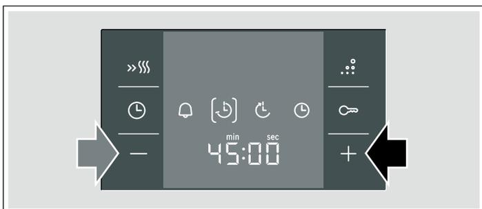
Через несколько секунд духовой шкаф включится. На индикаторной панели отображается отсчет заданного времени приготовления и светится символ
