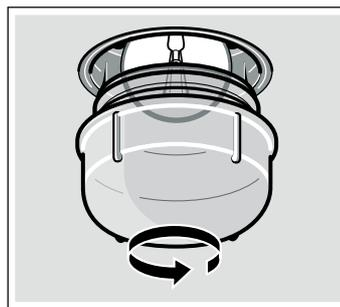
3. Wymienić lampkę na lampkę podobnego typu.
