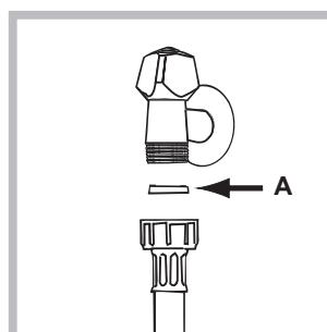
1. Вставте прокладку А у кінець шлангу для подачі води та вкрутіть його у кран з холодною водою з різьбою 3/4 (див. малюнок). Перед підключенням спустіть воду, доки вона не стане прозорою.
