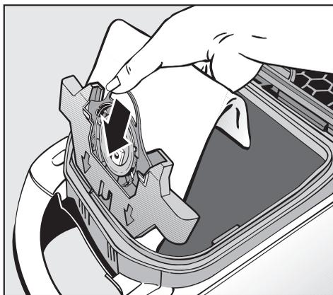
Блокировка включения пылесоса предотвращает закрытие крышки пылевого отсека, если не установлен мешок-пылесборник. Не применяйте силу!
