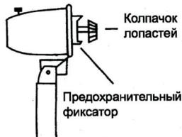
Наденьте заднюю решетку на стержень двигателя и закрепите фиксатором.
