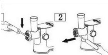
*Примечание: Если у вас не получается открутить прижимную гайку вручную, используйте для этого инструменты. Чтобы легко отделить решетку, поместите отвертку между решеткой и камерой мясорубки, а затем отодвиньте решетку отверткой.*
