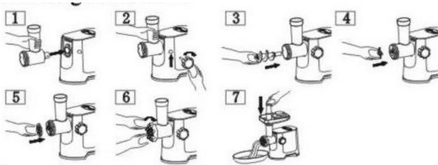
1. Удерживая камеру мясорубки, вставьте ее в отверстие на корпусе.
