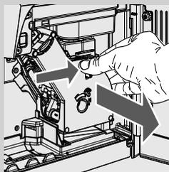
**4** Извлеките блок приготовления кофе, взяв его за ручку и нажав кнопку «PUSH». Блок приготовления кофе можно мыть только теплой водой без моющего средства.
