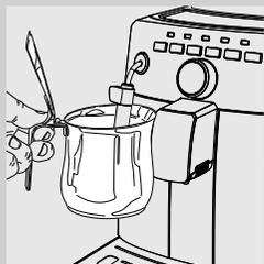
Чтобы избежать задерживания воды в контуре в течение длительного времени, перед первым запуском машины, а также после ее длительного простоя водный контур следует загрузить. Это позволит вам получить отличный свежий продукт.
