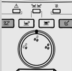
**4** По окончании подогрева машина выполнит цикл ополаскивания внутренних контуров; в течение всего цикла кнопки "☕" и "☕" будут мигать.
