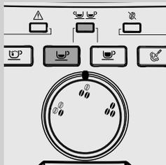
*Примечание: для подачи 2 кофе машина автоматически производит помол и дозировку нужного количества кофе. Приготовление двух кофе требует двух циклов помола и двух циклов подачи, которыми машина управляет автоматически.*
