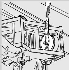
**5** Вымойте блок приготовления кофе теплой водой; тщательно промойте верхний фильтр. Перед тем как вставить блок приготовления кофе на место, убедитесь, что внутри камеры подачи не осталось воды.
