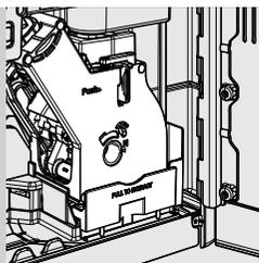
**3** Установите заново блок приготовления кофе в специальное отделение до достижения соединения БЕЗ нажатия на кнопку "PUSH". Вставьте контейнер для сбора жидких отходов.
