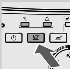
**2** Нажмите кнопку "☕". Следовательно, машина выполняет автоматическую загрузку контура, давая выйти количеству воды, определенному насадкой Pannarello.
