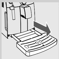
После выполнения цикла очистки от накипи слейте жидкость из поддона для сбора капель.
