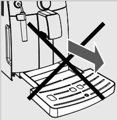
НИКОГДА не убирайте поддон для сбора капель при включенной машине. Подождите несколько минут после включения и/или выключения, поскольку машина будет выполнять цикл ополаскивания/самоочистки (см. параграф "Цикл ополаскивания/самоочистки").
