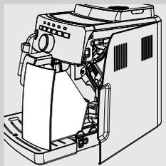
**1** Выключите машину, нажав на выключатель и извлеките штепсельную вилку из электрической розетки.
