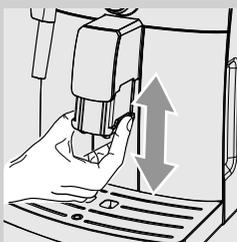
Для выполнения регулировки приподнимите и опустите вручную устройство подачи, поместив пальцы, как показано на рисунке.
