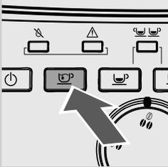
**5** Нажмите кнопку "☕", чтобы начать подачу горячей воды. Продолжайте подачу воды до сигнала о нехватке воды.
