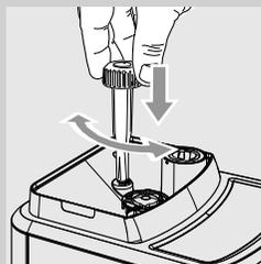
Нажмите и поверните ключ регулировки только на одно деление за раз и подайте 2-3 порции кофе; только таким образом можно заметить изменение степени помола.
