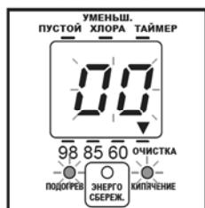
▶ Подается звуковой сигнал "бип бип бип бип", и индикаторы ПОДОГРЕВ и КИПЯЧЕНИЕ, а также дисплей мигают с высокой частотой.
