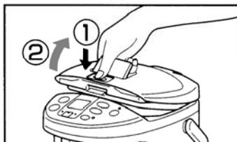
**2** Удерживайте рычаг освобождения крышки в верхнем положении. Нажмите на рычаг отсоединения крышки и снимите крышку под углом вверх.
