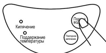
**Поддержание температуры** – после закипания воды термопот автоматически переключается в режим поддержания температуры и загорается индикатор «поддержание температуры». Нагрев воды также включается автоматически, если в термопот была добавлена холодная вода или температура воды упала ниже 80<sup>0</sup>С.
