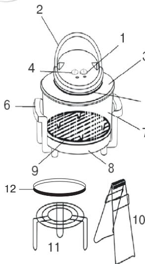
1. Ручка включения таймера
