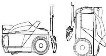
Зафиксируйте телескопическую трубку с насадкой на корпусе пылесоса, как показано на рисунке.
