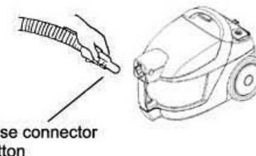
Вставьте соединитель гибкого шланга в воздухоприемное отверстие и нажмите, пока не услышите щелчок. Чтобы снять гибкий шланг, нажмите кнопку на соединителе гибкого шланга, а затем потяните и снимите шланг.
