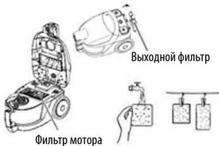
Извлеките фильтры и вымойте их проточной водой.
