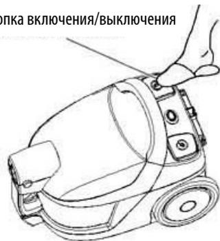
2. Нажмите кнопку включения/выключения, чтобы включить пылесос. Чтобы его выключить, нажмите кнопку еще раз.
