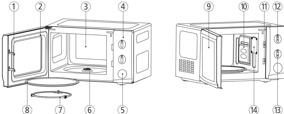
**① Замок дверцы** - Когда Вы закрываете дверцу печи, замок срабатывает автоматически. Если во время работы печи дверца будет открыта, то магнетрон автоматически выключается.
